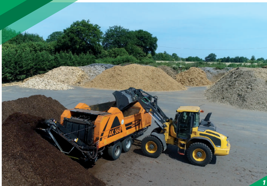
1. Broyage d'écorce en grille de 60 mm. 2. Broyage de bois SSD en grille de 80 mm.
