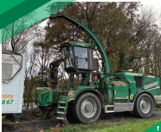
1. Chargement des camions possible par l'avant de la machine.
