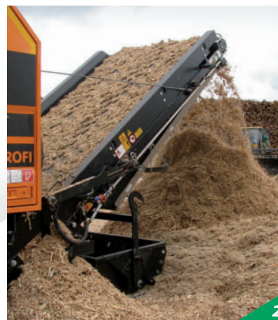
1. Broyage d'écorce en grille de 60 mm. 2. Broyage de bois SSD en grille de 80 mm.
