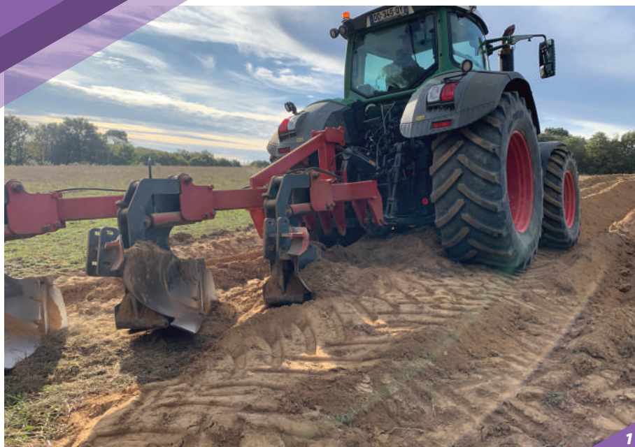
1. Charrue forestière renforcée disposant d'un grand dégagement entre le soc et le timon.
