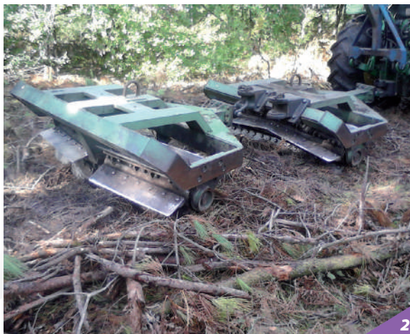
1. Interligne après passage d'un rouleau landais. 2. Le rouleau casse la fougère en un seul passage.
